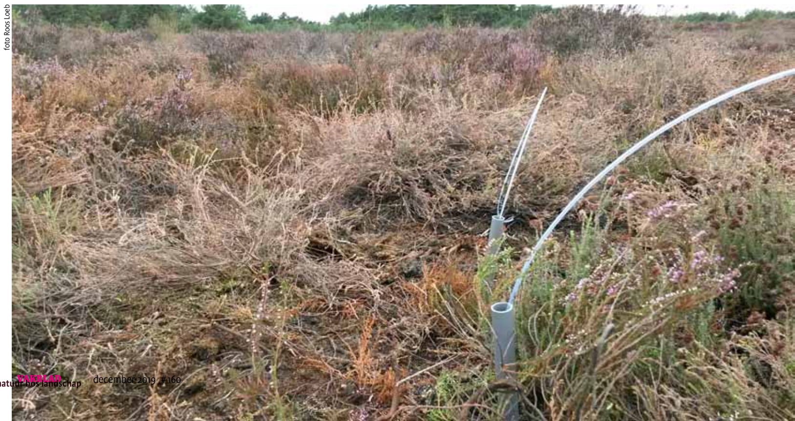
Foto 3. Beeld van de bovenzijde van de rizonporiewatersamplers (-40/45 cm beneden maaiveld) zoals deze zijn geïnstalleerd op drie locaties met oude, ongeplagde heide (Strabrechtse heide, 14-08-2018). Duidelijk is te zien dat een deel van de heidebegroeiing flink heeft geleden onder de extreme droogte van 2018.
