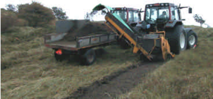
Figuur 1: De toplaag van de bodem wordt samen met de verruigde vegetatie op het Rozenwaterveld verwijderd door een plagmachine.
